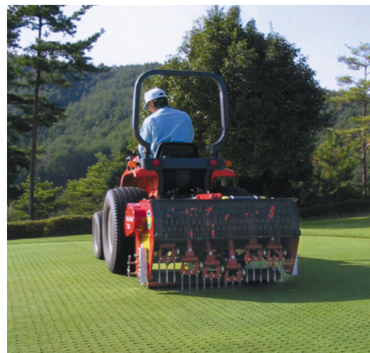
Aerifikace plnými hroty po zapískování
